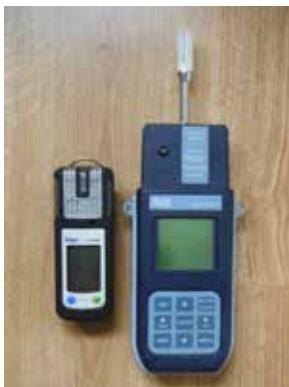
Figura 3. Arriba. Detector utilizado en las primeras mediciones. GIG Microtector II G450 (Bomberos Excm. Diputación de Cuenca). , Medidor de temperatura y humedad (no profesional).
