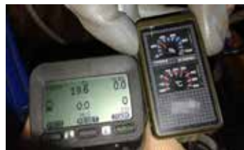
Figura 3. Arriba. Detector utilizado en las primeras mediciones. GIG Microtector II G450 (Bomberos Excm. Diputación de Cuenca). , Medidor de temperatura y humedad (no profesional).
